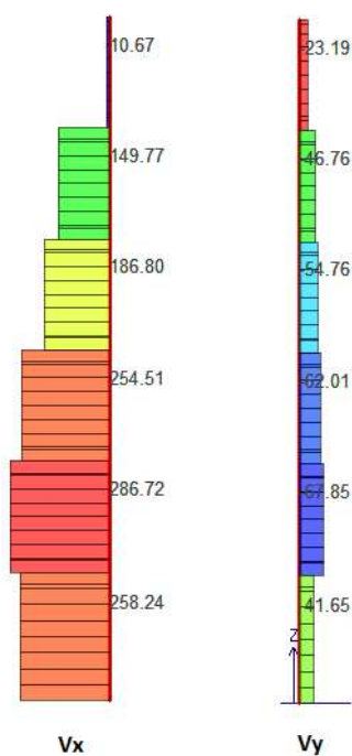
Fig.24.Tagli combinazione sismica più gravosa agente sulla pilastrata
